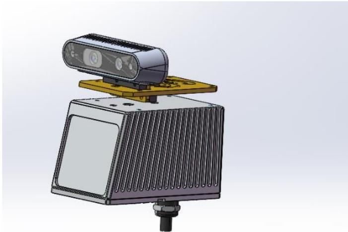
图2-7 Realsense 转接板
