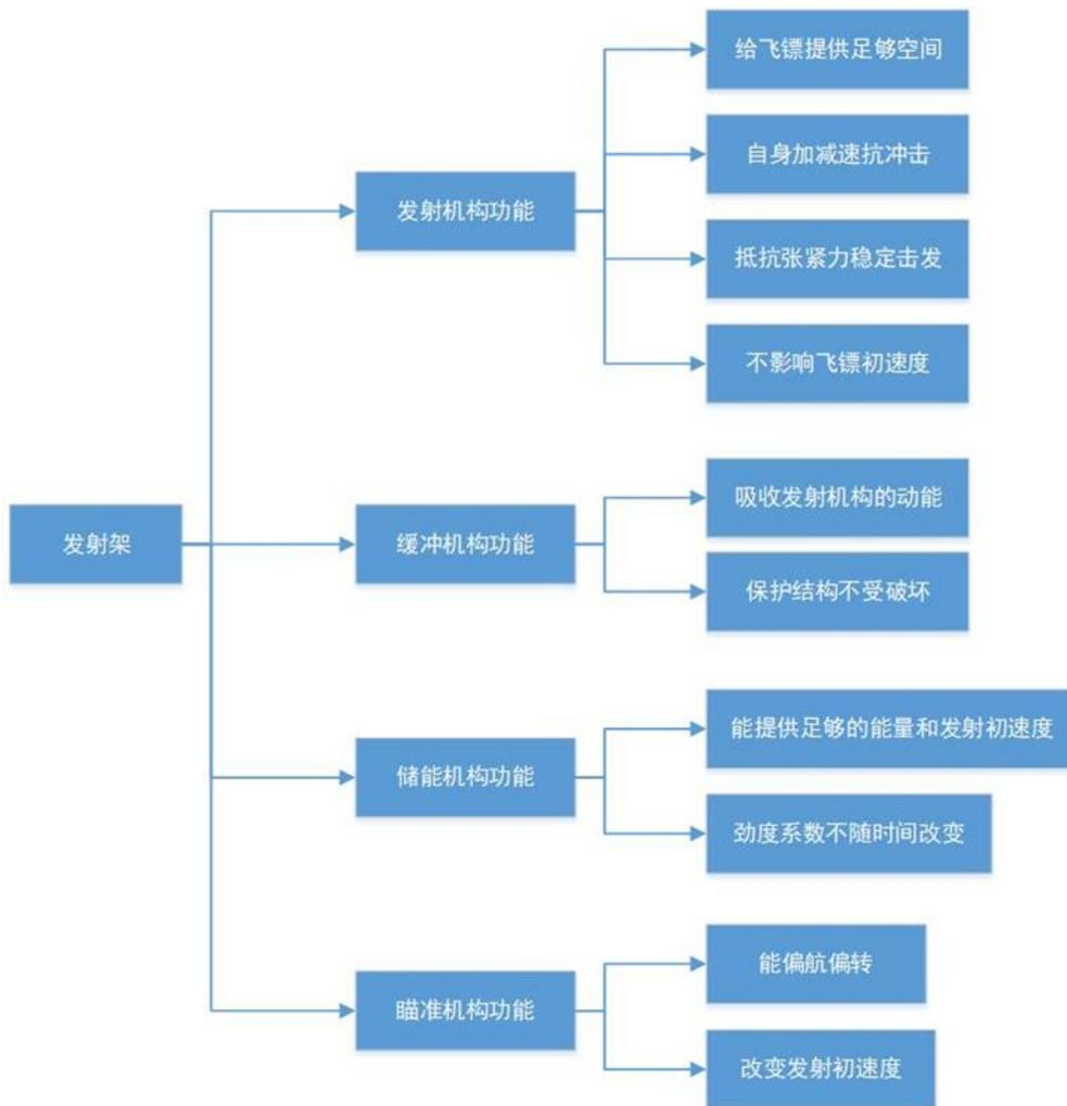
图 6.2.2 飞镖发射架功能定义
