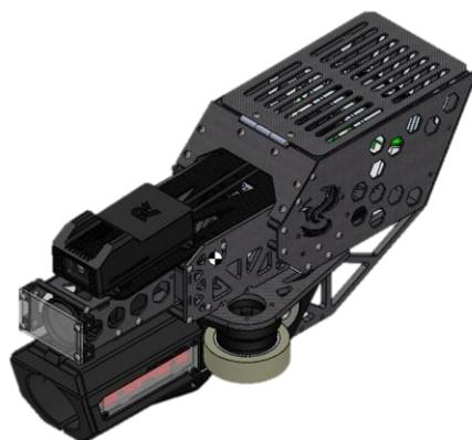
发射机构采用了无枪管构型，42mm 弹丸接触摩擦轮后即与枪管无接触。此构型避免了由于弹丸与枪管内壁碰撞造成的精度损失，同时避免了枪管加工公差造成的散布增大。相比于往年有枪管构型，10m/s 射速下命中率提升约 40%，16m/s 射速提升约 20%（实验结果未严格控制变量，仅供参考）。
