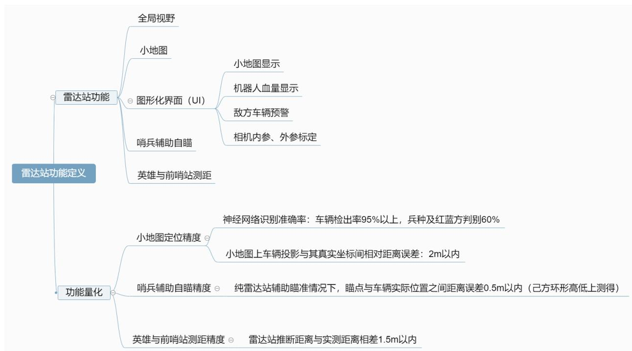
图2-1 机器人功能定义
