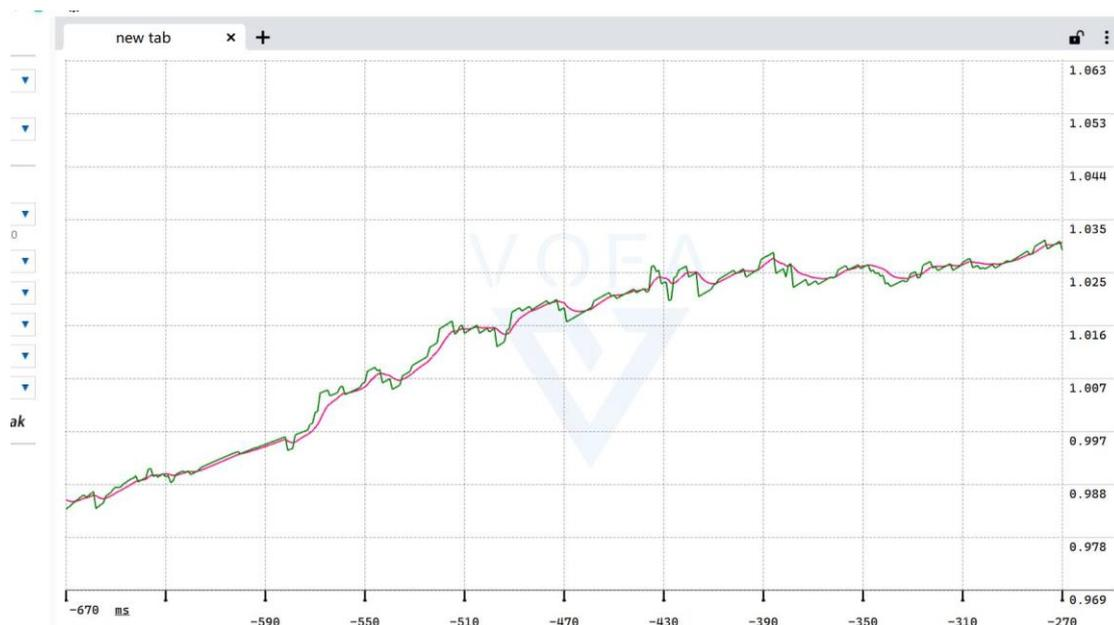
如图所示，绿色线为 PnP 解算得到的位置曲线，红色线为卡尔曼滤波后位置曲线，可见卡尔曼滤波器有较好的数据平滑效果。而通过设置较大的过程噪声方差和较小的观测噪声方
