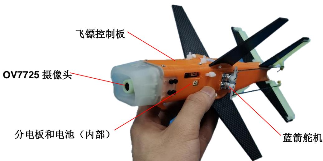
图 6.4.2.3 飞镖硬件结构图
